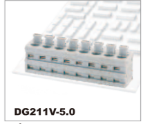
DG211V-5.0 250B/15A 0.2-1.5mm 2 300B/8A 26-16AWG Полосов 1P-XXP
