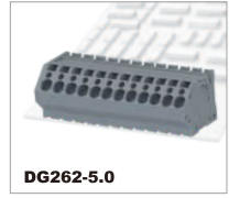
DG262-5.0 320B/32A 0.2-4.0mm 2 300B/20A 28-12AWG Полосов 1P-XXP
