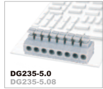
DG235-5.0 DG235-5.08 450B/15A 0.2-2.5 SOL 0.2-1.5 STR 300B/5A 20-18AWG Полосов 1P-XXP
