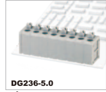
DG236-5.0 400B/10A 0.2-1.5mm 2 300B/8A 20-16AWG Полосов 1P-XXP
