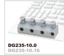
DG235-10.0 DG235-10.16 750B/15A 0.2-2.5 SOL 0.2-1.5 STR 300B/5A 20-18AWG Полосов 1P-XXP
